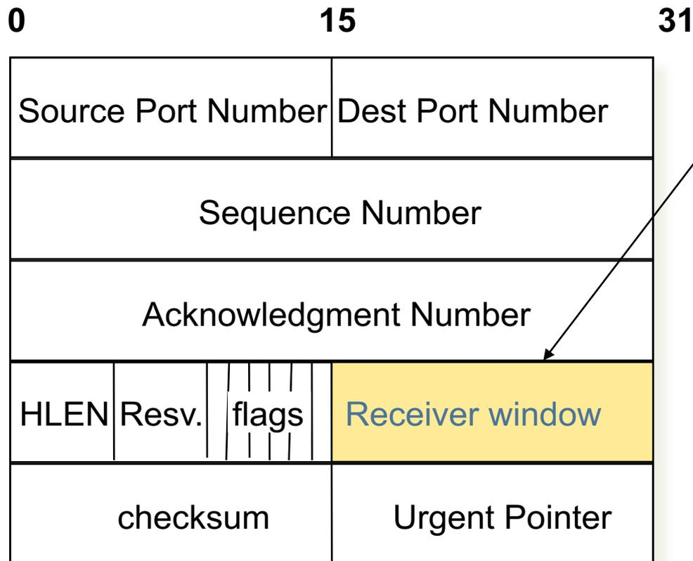
Numero di byte, a partire da quello nel campo di ACK, che il ricevitore è disposto ad accettare per controllo di flusso
