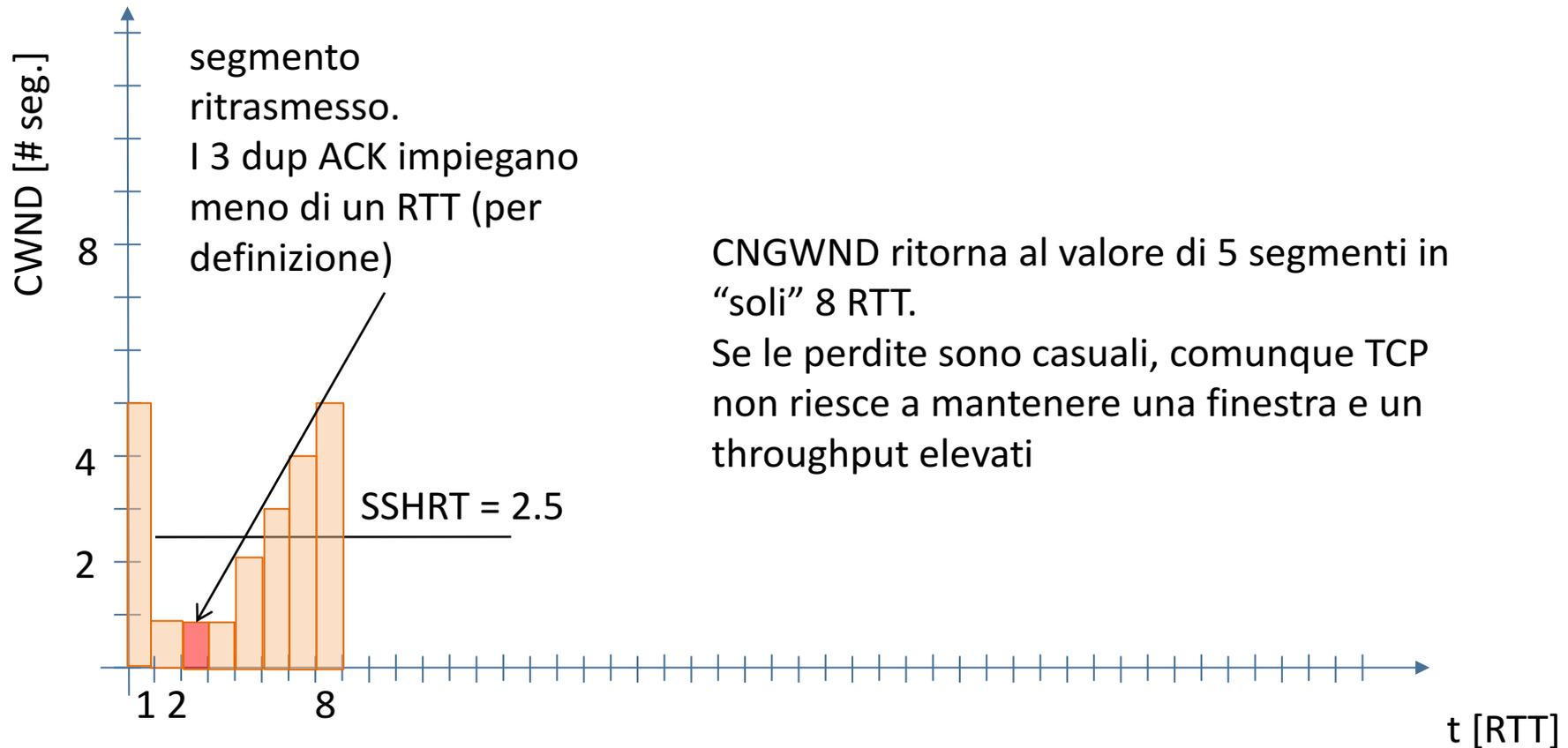
Dinamica della finestra:  $RTT = 20\text{ms}$ ;  $RTO = 200\text{ms}$ ;  $RCWND = 40$  segmenti ( $\sim 64\text{K}$ )
