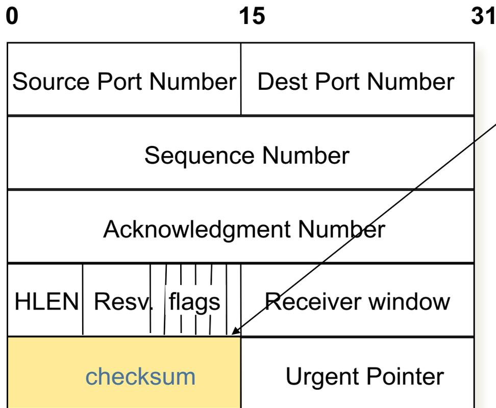
Checksum obbligatorio su header e dati, più pseudo-header che include indirizzi IP e tipo di protocollo (violazione del principio di stratificazione OSI)
