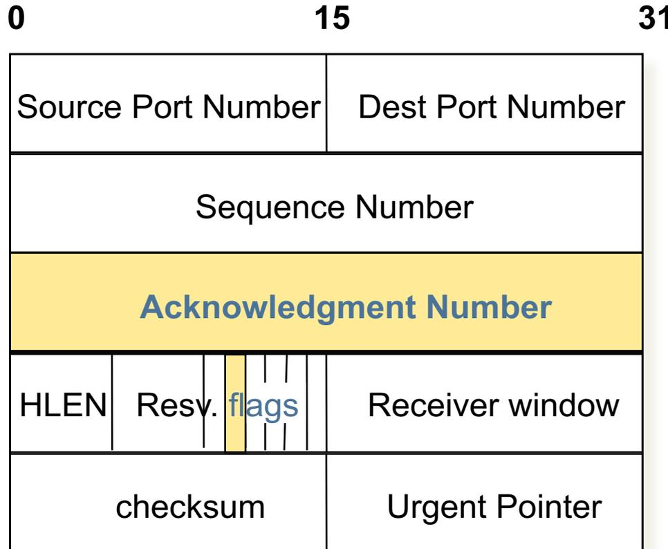
Numero di sequenza più 1 dell'ultimo byte di dati ricevuto correttamente e in sequenza
