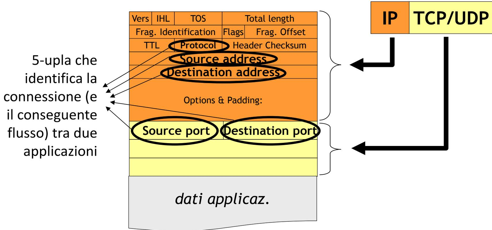
La 5-upla **{S-IP,D-IP,PROT,S-Port,D-Port}** identifica in modo univoco un flusso in qualsiasi punto della rete ... e quindi anche all'interfaccia tra protocollo applicativo e protocollo di trasporto in un host
