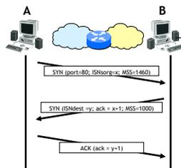
A annuncia a B di poter accettare solo segmenti la cui dimensione massima del campo dati è pari a 1460 byte;
